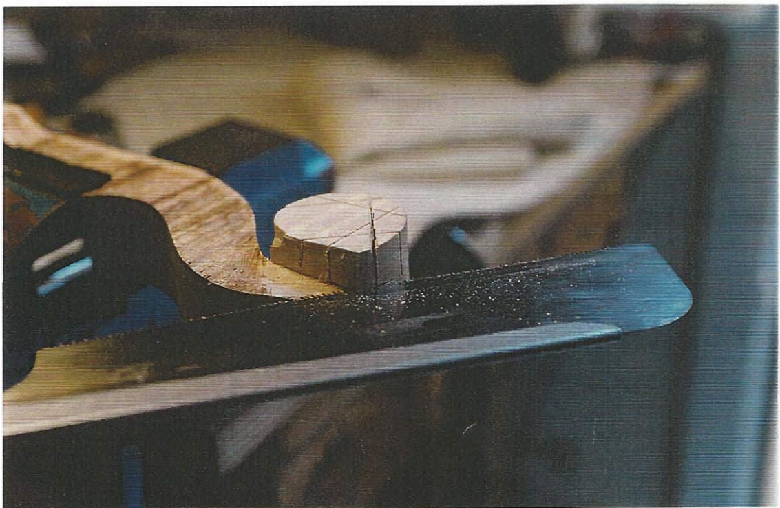
CHANTOURNAGE DU MANCHE ET DEGROSSISSAGE DE LA VOLUTE, A LA SCIE
