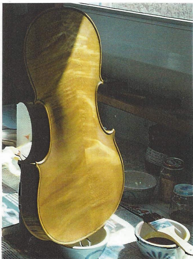
PASSAGE DU FOND DE BOIS PUIS DES COUCHES DE VERNIS AU PINCEAU
