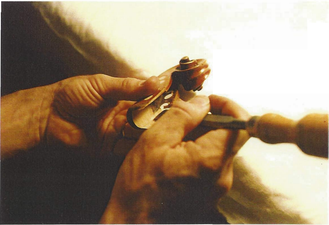
PREPARATION DE L'ENTAILLE REALISEE DANS LE CHEVILLIER
