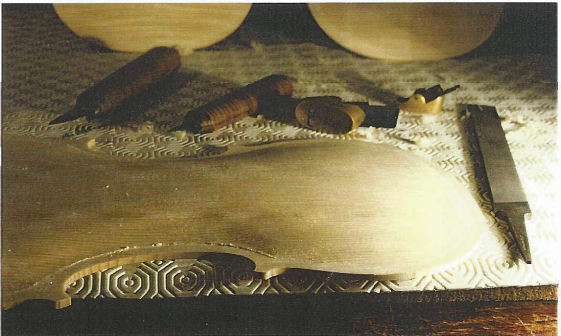
REGLAGE DE L'ÉPAISSEUR DES BORDS ET ROGNAGE AU CANIF DU CONTOUR DE LA TABLE ET DU FOND
