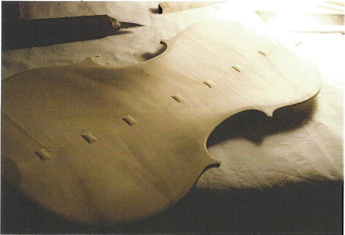
INTERIEUR DU FOND TERMINE, AVEC PETITS TAQUETS DE RENFORT SUR LE JOINT
